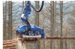
木を**伐倒**し、さらに指定の長さに**自動的に造材**するハーベスタ
