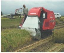
〈クローラータイプの専用収穫機〉
