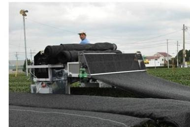
被覆資材の設置・除去装置の開発
