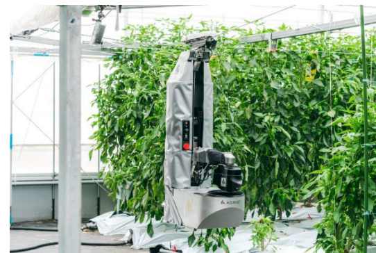
ピーマン収穫ロボット
