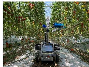
トマト収穫ロボットによる収穫の様子
