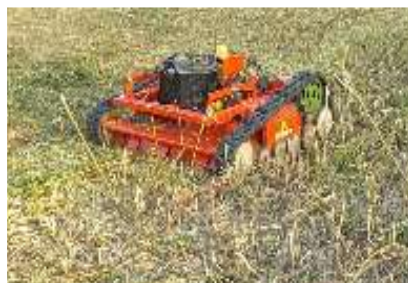
リモコン草刈り機による畦畔管理作業
