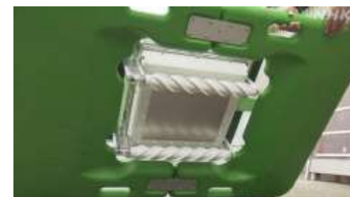
螺旋状スクリューで、 稲を引き抜くことなく進む
