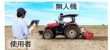
ほ場周囲からの監視による自動走行
