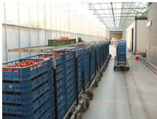
〔トマト温室内の自動運搬装置〕
