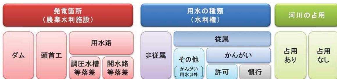
図-2 小水力発電の設置条件パターン
