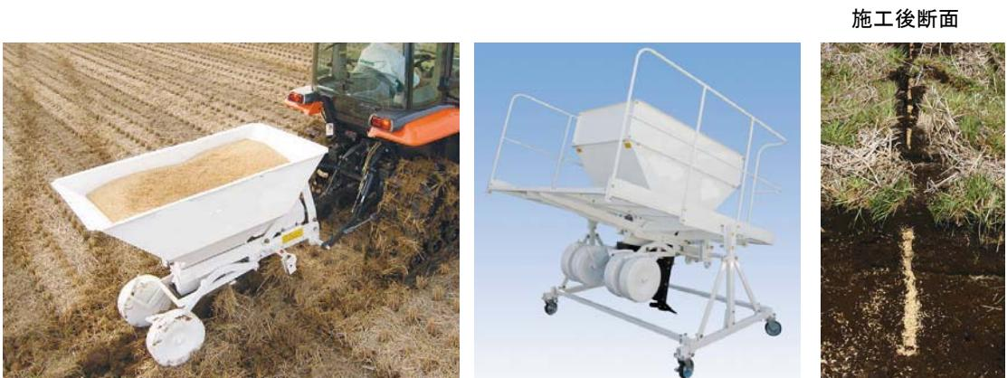
写真-29.1 疏水材心土充填機によるモミガラ補助暗渠工法
