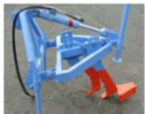
写真-26.2 せん孔暗渠による工法
