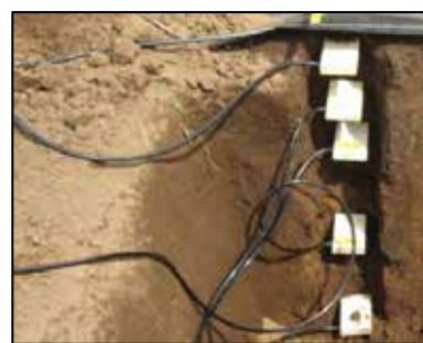
写真-5.2 誘電率水分計 (TDR 法) 設置状況
