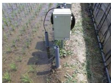
写真-6.10 水位センサー式水位計設置例 2
