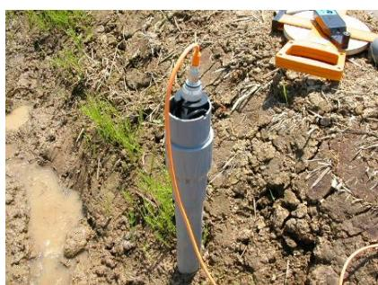
写真-6.9 水位センサー式水位計設置例 1
