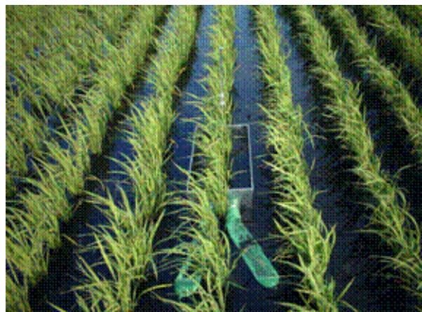
写真-6.6 N型減水深測定器設置例
