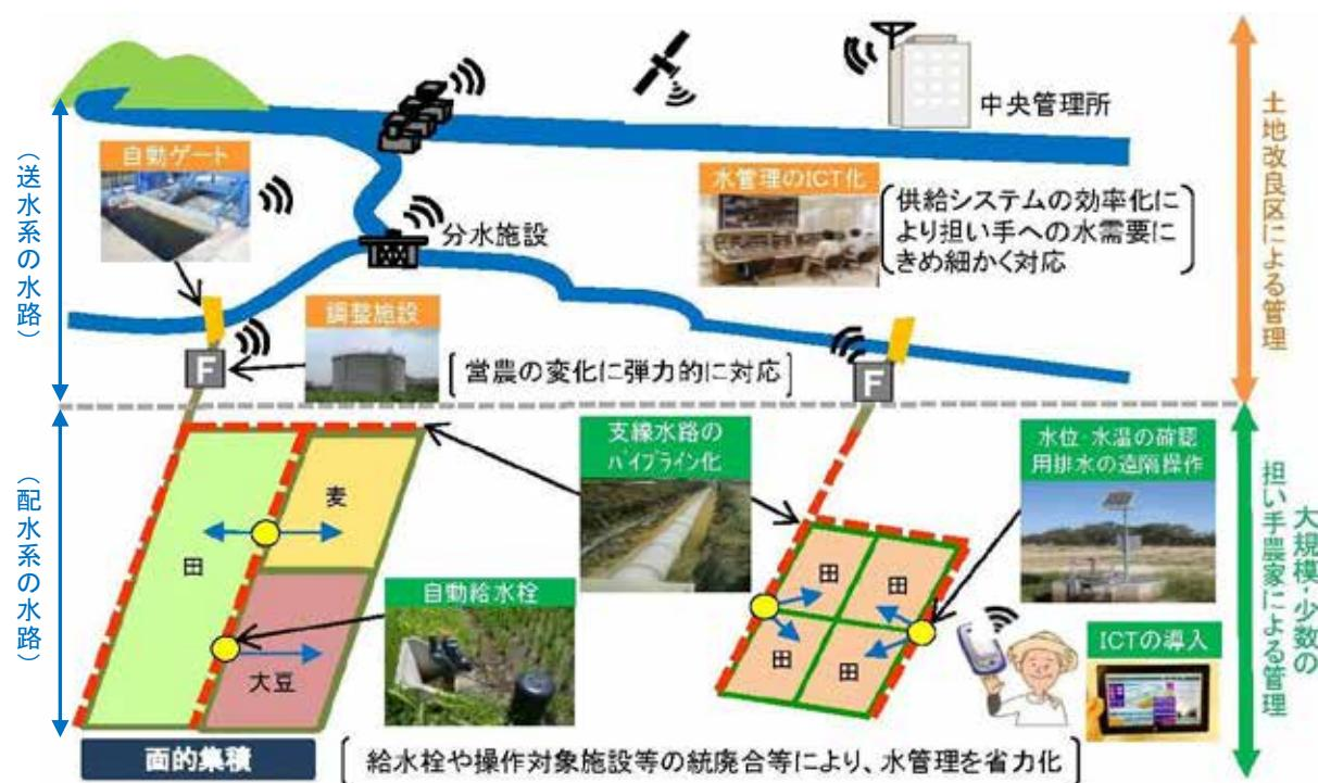
図-40.4 需要主導型の送配水システムのイメージ
