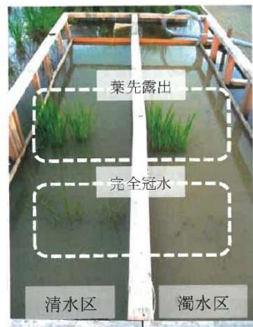
図-5.5 冠水試験中の様子
