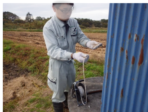
④押さえた位置の目盛りを読み取ります。この値が、地下水位の深さです。
