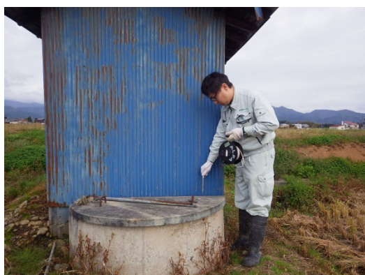
①手測式水位計のセンサーを、井戸の中に下ろします。
