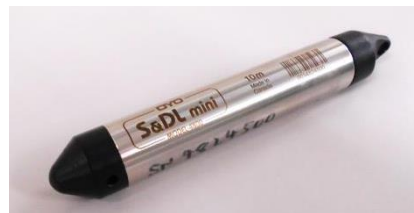
写2 投込型圧力式 自記水位計（例）
