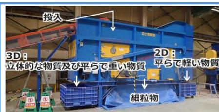
写真: 可燃物を効率的に回収するための混合廃棄物を形状によって選別する機械
