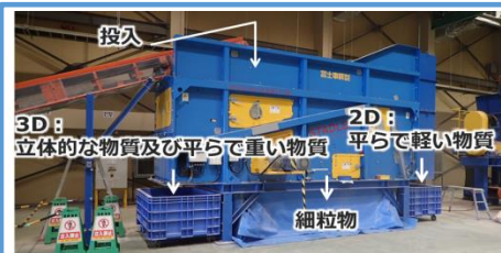
写真: 可燃物を効率的に回収するための混合廃棄物を形状によって選別する機械
