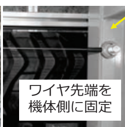
ワイヤセンサ (後進速度変化把握用) →停止距離に換算 (あるいは実測)
