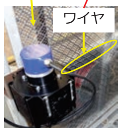
ワイヤセンサ (後進速度変化把握用) →停止距離に換算 (あるいは実測)
