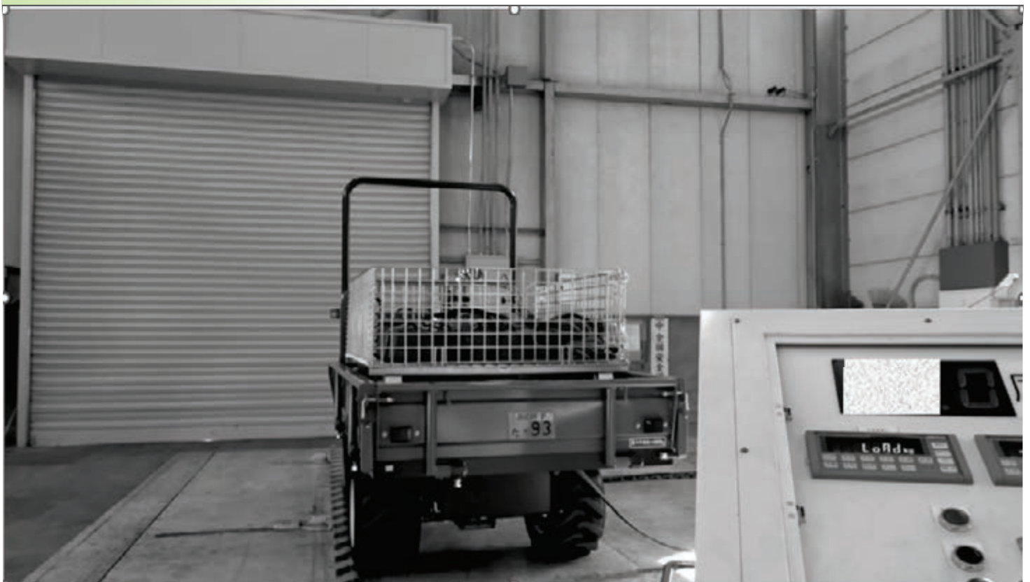
左側転倒（偏荷重） ※左が不利側（右よりも転倒角が小さい）
