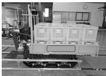
図2-2 コンテナ積載状態（等荷重）
