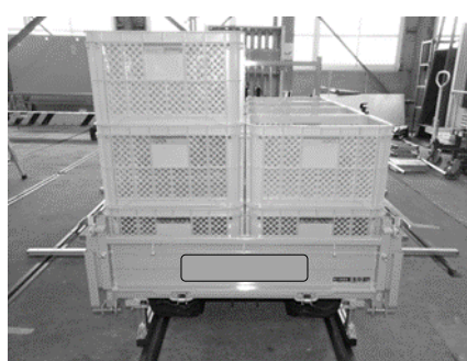
図 2-5 コンテナ積載状態 （偏荷重）
