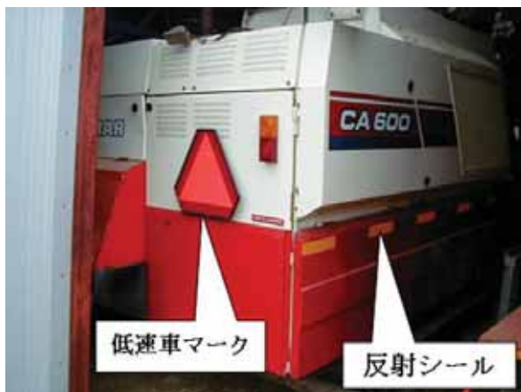
低速車マークおよび反射シールの貼付したコンバイン
