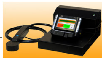
豚肉脂質測定装置プロトタイプ機
