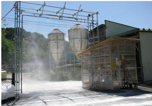
消毒ゲートを自作した事例【牛農場】※上部及び左右から消毒液を噴霧。車両消毒装置は自作。
