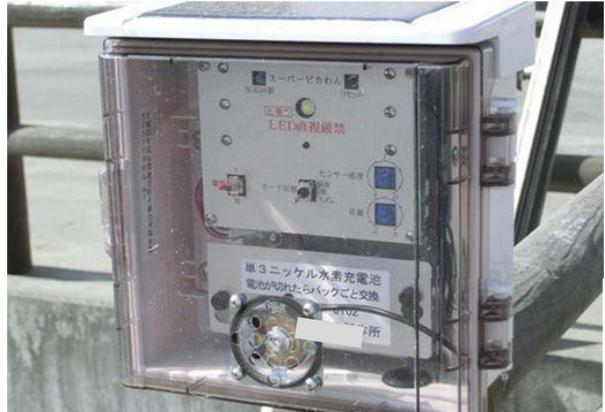
犬の鳴声の音声を流すことによりイノシシ及びカラスの侵入を防除している事例【牛農場】
