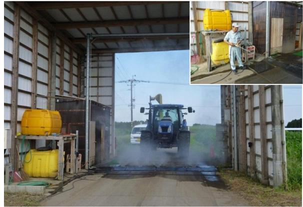
屋根付き上屋を備えた噴霧機及び消毒マットによる車両消毒の事例【牛農場】※全天候で使用可能。来場者は小屋で記帳し、細霧装置及び靴底マットにて消毒を実施。車両消毒装置は自作(内1/3は町及び経済連からの補助金)。
